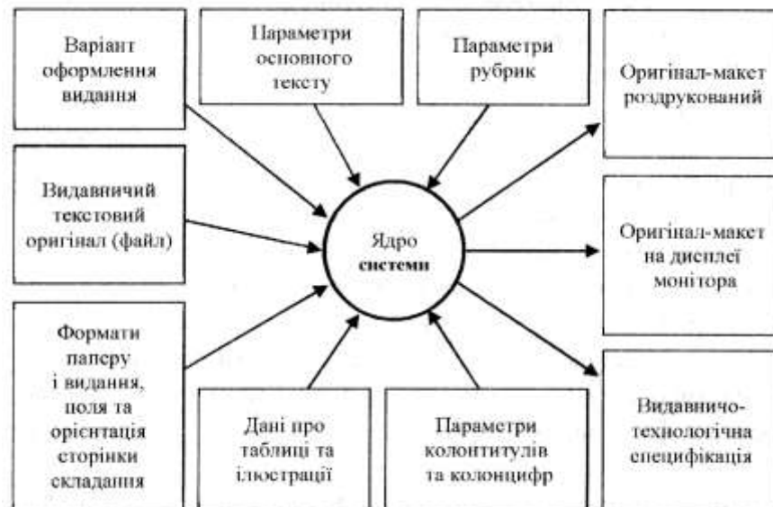
Рис. 1. Узагальнена модель автоматизованої системи проектування книжкових видань.
